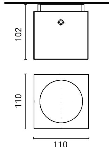
Apparecchio illuminante da esterno per installazione a soffitto
