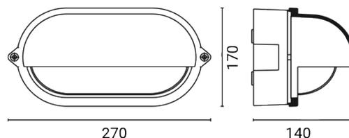
Luminaria de exterior para instalación en pared
