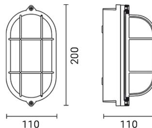
Luminaria de exterior para instalación en pared/techo
