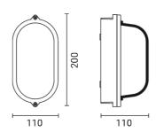
Luminaire d'extérieur pour installation au mur/plafond
