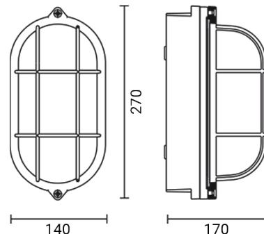
Luminaire d'extérieur pour installation au mur/plafond
