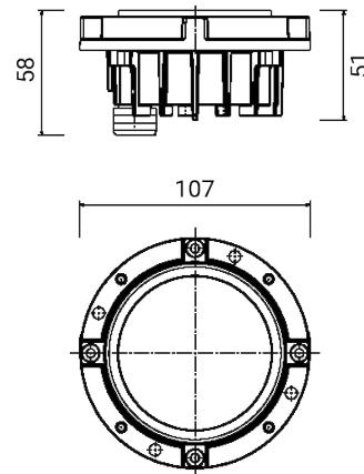
Luminaire encastrable d'extérieur pour installation au sol/au mur
