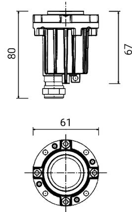
Luminaria de exterior empotrable para instalación en suelo/pared
