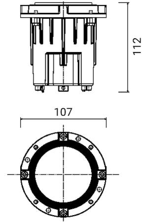
Luminaire encastrable d'extérieur pour installation au sol/au mur
