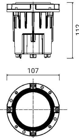
Luminaria de exterior empotrable para instalación en suelo/pared
