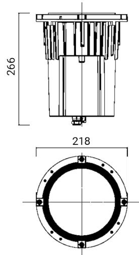
Luminaria de exterior empotrable para instalación en el suelo
