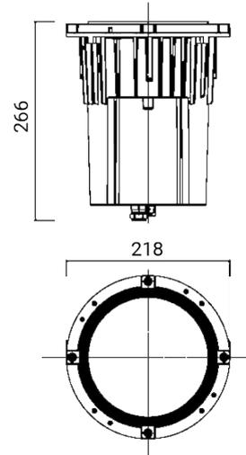
Luminaire encastrable d'extérieur pour installation au sol
