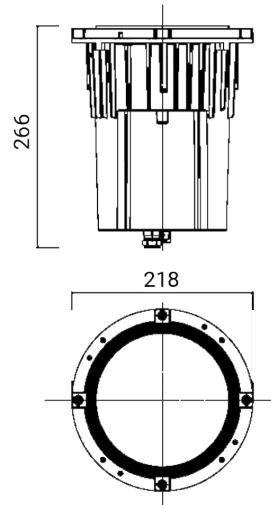
Luminaire encastrable d'extérieur pour installation au sol
