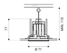
Luminaria de exterior empotrable para instalación en techo
