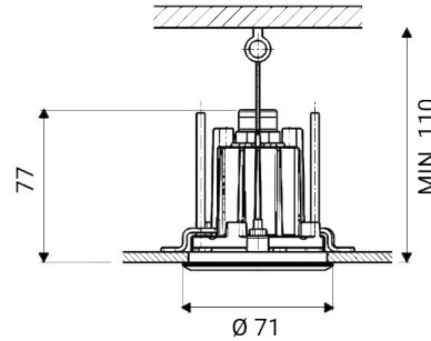
Luminaire encastrable d'extérieur pour installation au plafond
