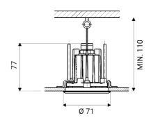
Luminaire encastrable d'extérieur pour installation au plafond
