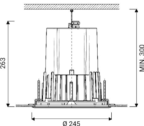
Luminaire encastrable d'extérieur pour installation au plafond
