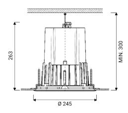
Luminaire encastrable d'extérieur pour installation au plafond
