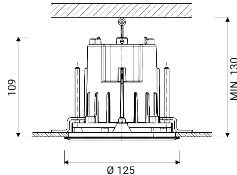
Luminaria de exterior empotrable para instalación en techo
