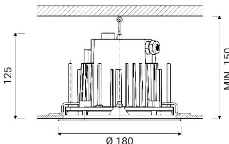
Luminaire encastrable d'extérieur pour installation au plafond
