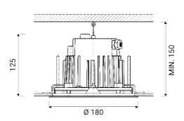
Luminaire encastrable d'extérieur pour installation au plafond
