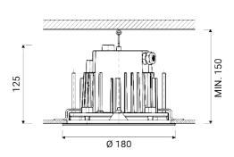
Luminaire encastrable d'extérieur pour installation au plafond
