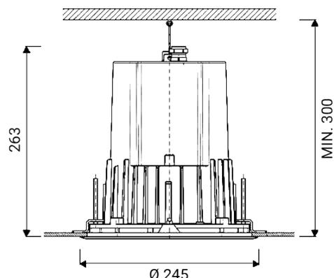
Luminaire encastrable d'extérieur pour installation au plafond
