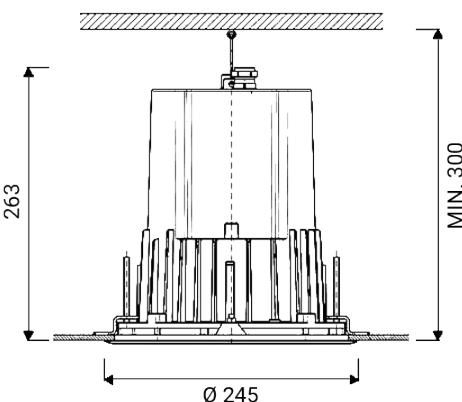
Luminaria de exterior empotrable para instalación en techo
