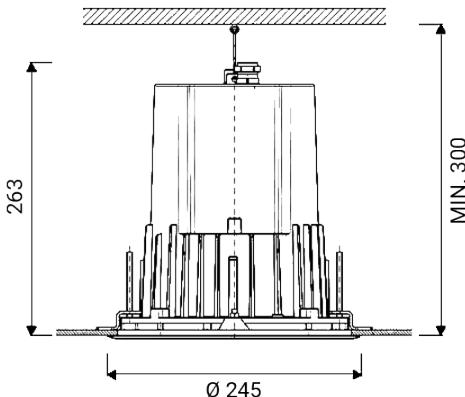
Luminaire encastrable d'extérieur pour installation au plafond
