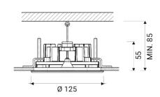
Luminaria de exterior empotrable para instalación en techo
