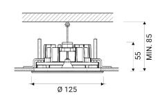
Luminaire encastrable d'extérieur pour installation au plafond
