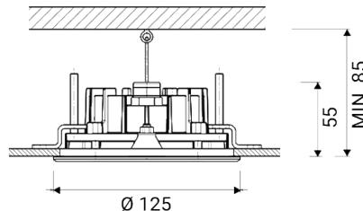
Luminaire encastrable d'extérieur pour installation au plafond
