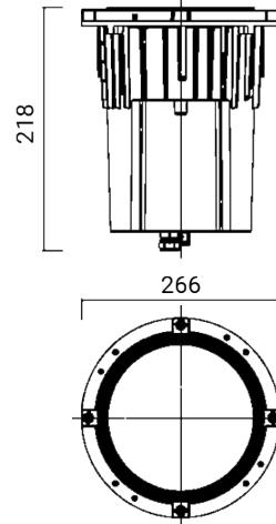
Luminaria de exterior empotrable para instalación en el suelo
