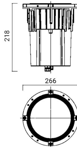
Luminaire encastrable d'extérieur pour installation au sol
