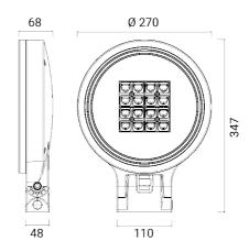
Proyector de exterior para instalación en pared, poste y suelo
