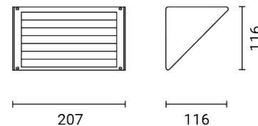
Luminaire d'extérieur pour installation au mur/plafond
