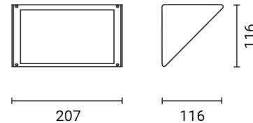
Luminaria de exterior para instalación en pared/techo
