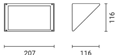
Luminaire d'extérieur pour installation au mur/plafond
