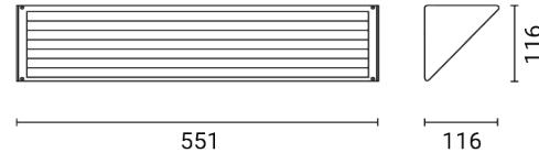
Luminaria de exterior para instalación en pared/techo
