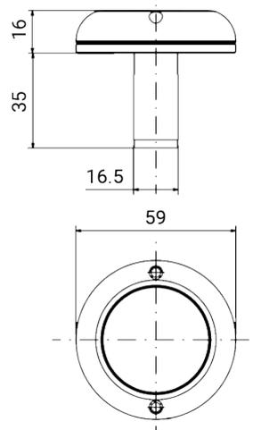
Luminaria de exterior transitable para instalación en superficie en el suelo
