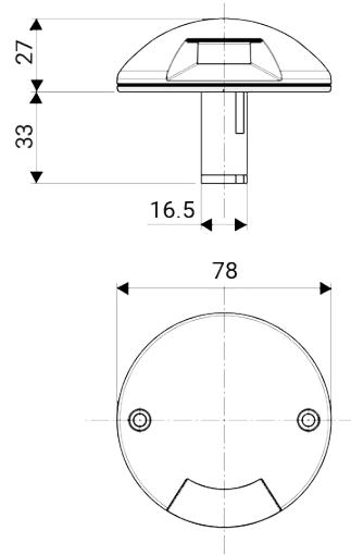
Begehbarer Bodenaufbauleuchte für den Außenbereich
