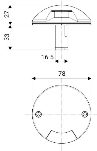
Luminaire praticable d'extérieur pour installation au sol en surface
