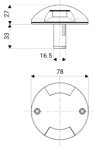
Luminaria de exterior transitable para instalación en superficie en el suelo
