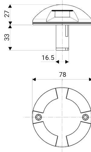
Luminaire praticable d'extérieur pour installation au sol en surface
