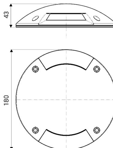
Luminaire praticable d'extérieur pour installation au sol en surface
