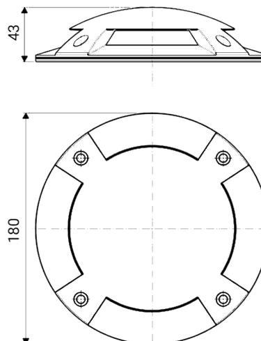
Luminaria de exterior transitable para instalación en superficie en el suelo
