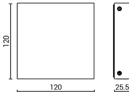
Luminaria de exterior señalador del recorrido con espesor mínimo para instalación en superficie en pared
