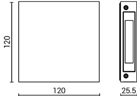
Luminaire de balisage d'extérieur avec épaisseur minimale pour installation murale en surface
