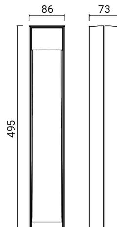
Quaderförmiger Garten-Pollerleuchte mit nach unten gerichtetem Frontlicht, geschützt durch Blendschutzklappe, zur Beleuchtung von Wegen, Passagen und Pfaden
