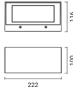
Luminaria de exterior para instalación en pared
