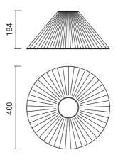
Paraluce con speciale rigatura interna frangiluce Materiale: policarbonato anti UV
