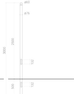
Mast Ø 76 mm aus elektrogeschweißtem Rohr, feuerverzinkt und lackiert / Höhe über Grund 2,50 m + 0,50 m zu vergraben (Gesamthöhe des Mastes = 3,00 m)
