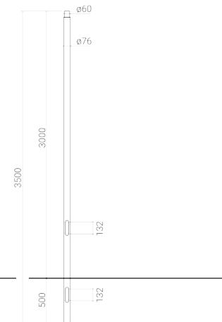
Palo Ø 76 mm ricavato da tubo elettrosaldato, zincato a caldo e verniciato / Altezza fuori terra 3,00 m + 0,50 m da interrare (altezza complessiva del palo = 3,50 m)
