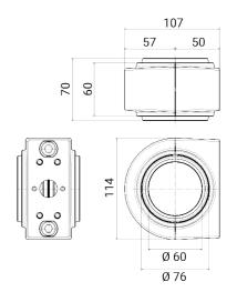
Attacco singolo Per pali Ø 60-76 mm e pali serie PROTO Materiale: alluminio pressofuso
