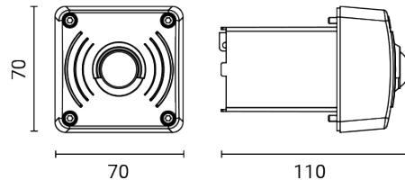
Rilevatore di presenza a raggi infrarossi con tre regolazioni:
