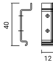
Paire d'étriers pour permettre la fixation du luminaire SUPERMAXI sur la goulotte réf. 5692
