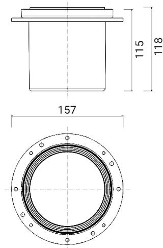
Luminaire encastrable d'extérieur pour installation au sol/au mur
