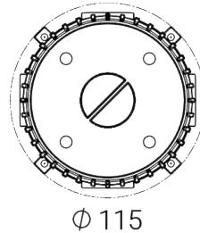
Einbaukasten mit Schutzdeckel für komplette flächenbündige Installation
