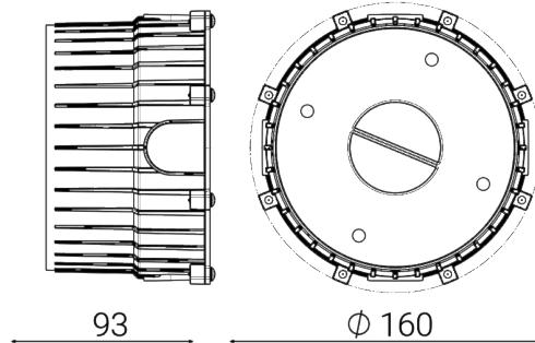
Einbaukasten mit Schutzdeckel für komplette flächenbündige Installation
